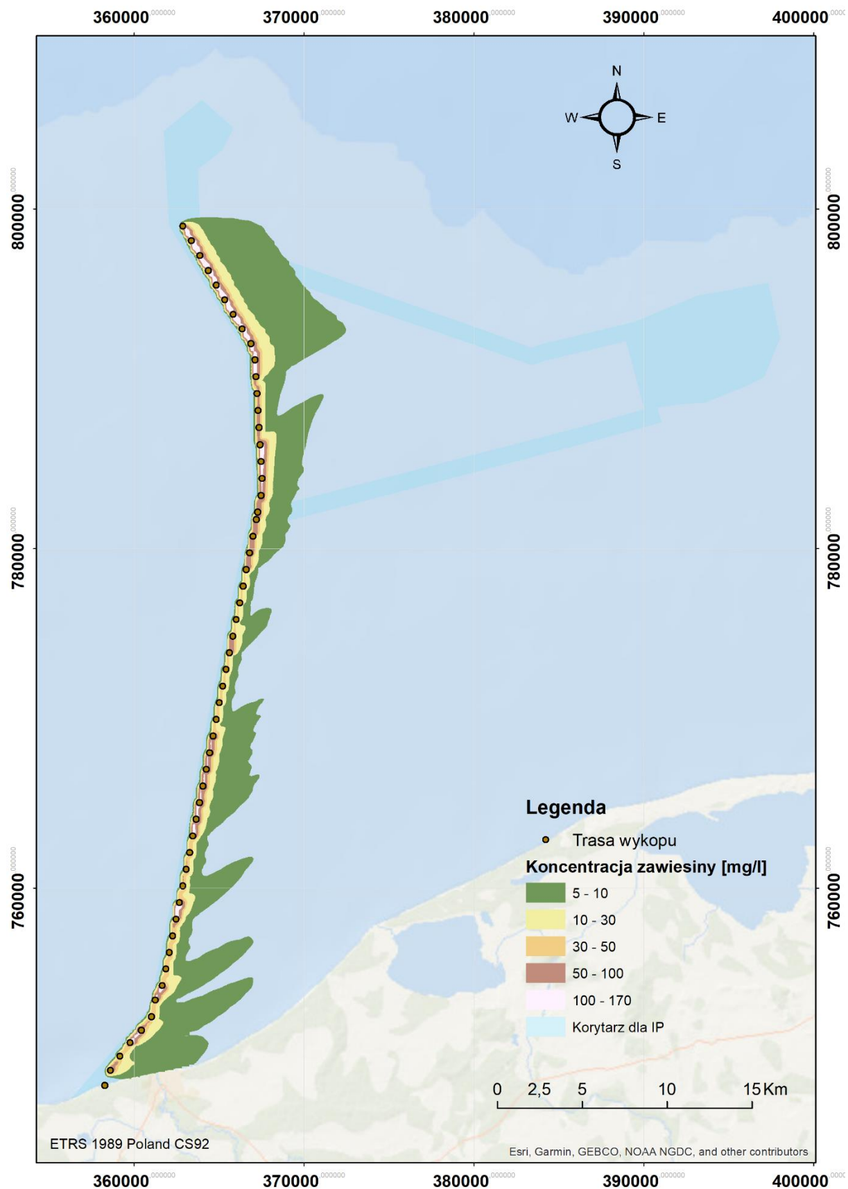
Rys. 37 Maksymalne koncentracje zawiesiny w warstwie przydennej wyznaczone w każdym węźle siatki podczas procesu zagłębiania kabla na trasie do MFW Bałtyk II w przypadku scenariusza V100, wartość graniczna 5 mg/l
