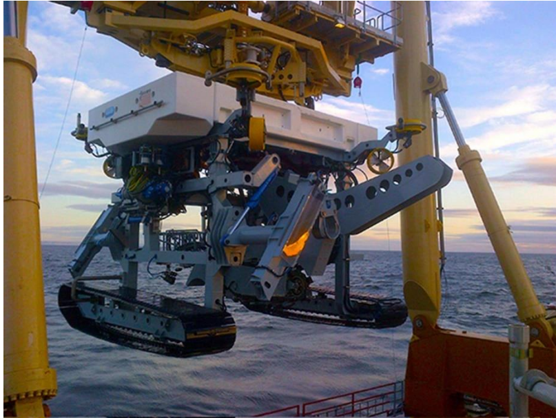
Rys. 3.8. Przykładowe urządzenie do zakopywania kabli
