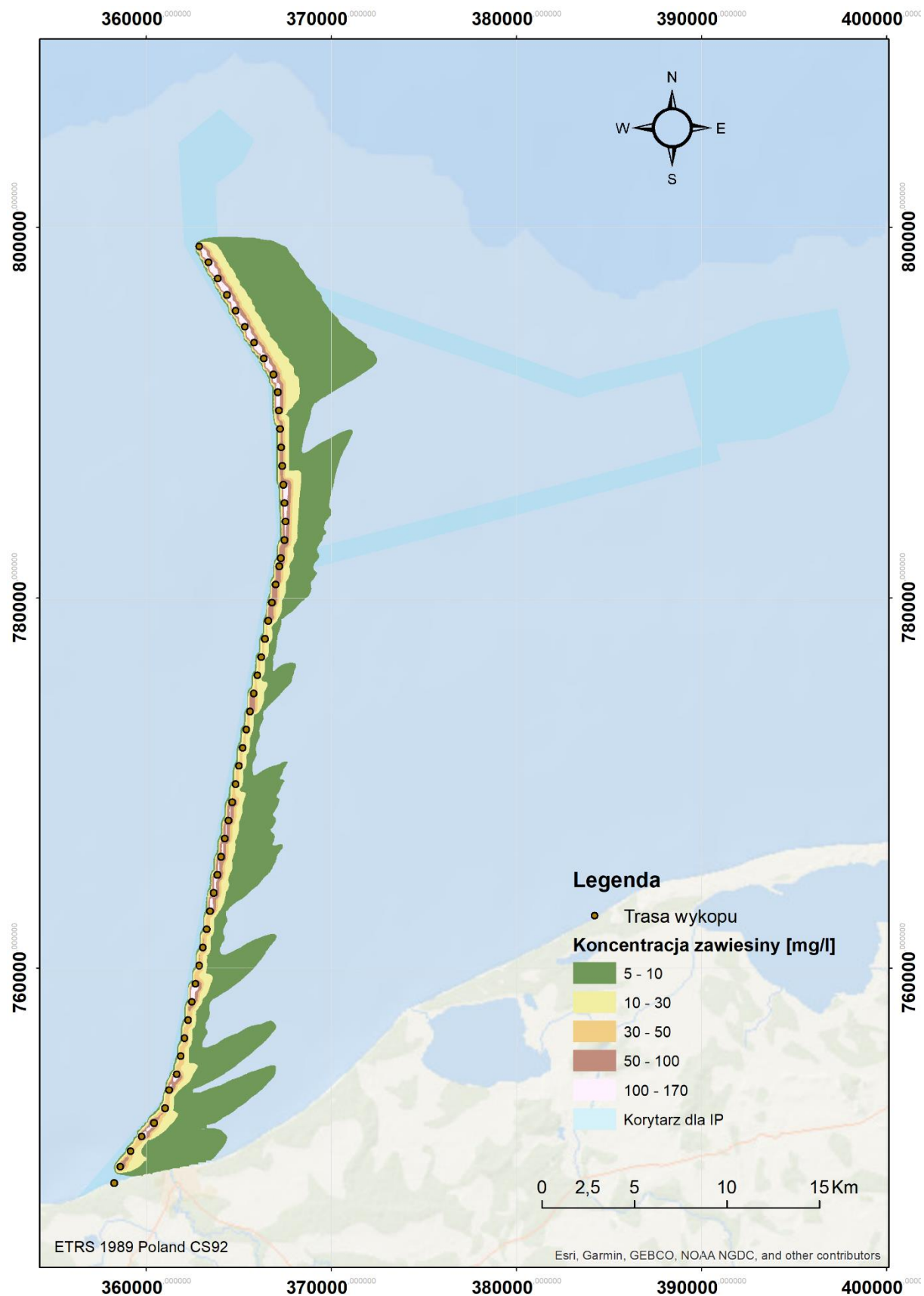
Rys. 17 Maksymalne koncentracje zawiesiny w całej kolumnie wody wyznaczone w każdym węźle siatki podczas procesu zagłębiania kabla na trasie do MFW Bałtyk II w przypadku scenariusza V100, wartość graniczna 5 mg/l
