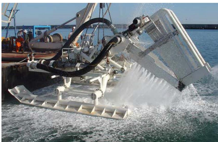
Fotografia 8. Sanie rozmywające grunt
